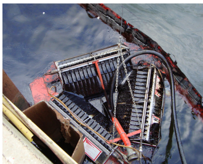
Skadeservice specialbyggda oljeskimmer, tar upp 12 ton / timma.
