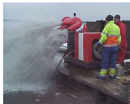
Eldriven pump med kapacitet på 30.000 minutiliter.
